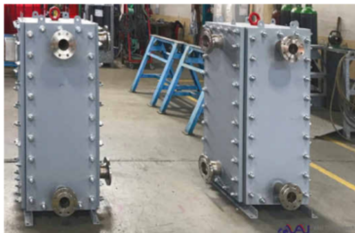
Aufgrund des teilweise hohen Verschmutzungsgrades der Medien besitzen alle Plattenwärmetauscher demontierbare Rechteckdeckel. Dadurch ist eine leichtere Reinigung möglich.
